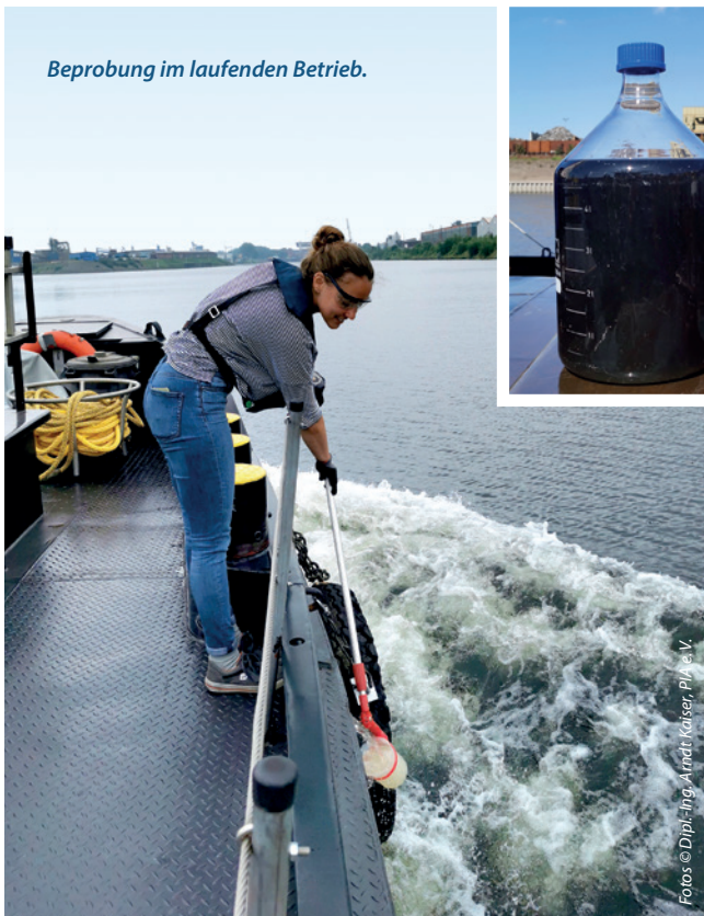
Bilgenwasser-Proben im Zu- und Ablauf einer Ultrafiltrationsanlage.
