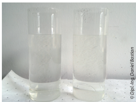
Ablauf des Membranbioreaktors mit PAK-Dosierung.
