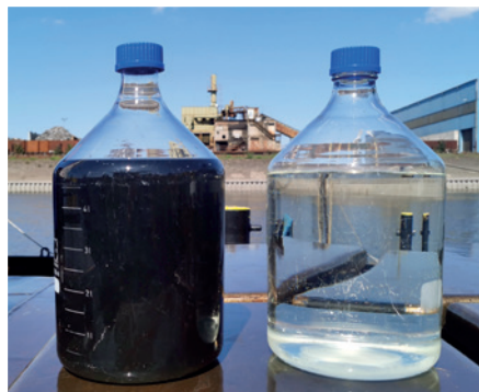
Bilgenwasser-Proben im Zu- und Ablauf einer Ultrafiltrationsanlage.
